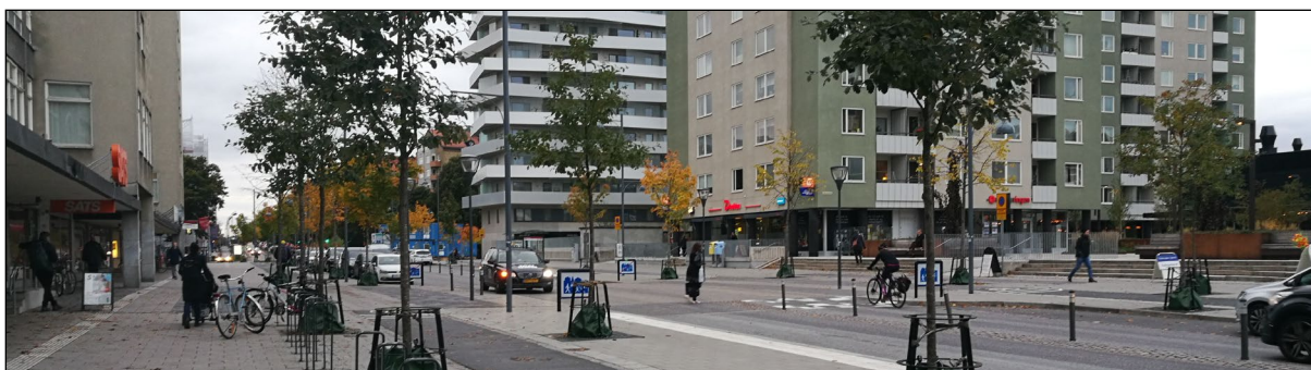
Foto 3, exempel på passage över huvudgata (Tulegatan i Sundbyberg). I detta fall en kort skyltad gångfartsgata, där biltrafiken ska anpassas till de gående. En av nackdelarna är trygghetsfaktorn, då trafiken endast saktar ned då någon rör sig ut i gatan. Därmed finns det en ordentlig tröskel att som gående våga sig ut och över gatan. En fördel är flexibiliteten, och att trafiken inte stannas upp långa perioder.
